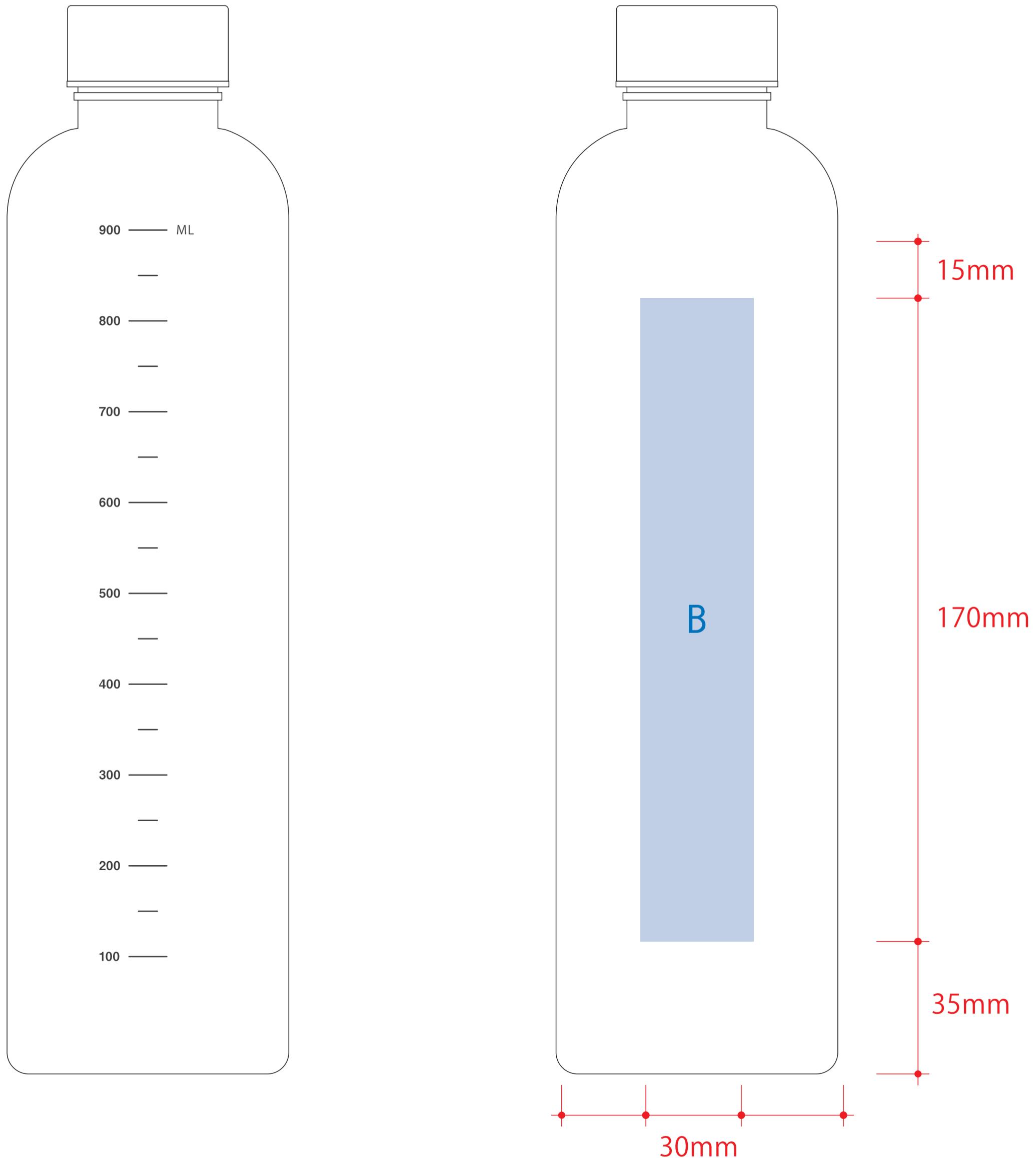
インクジェット印刷 最大範囲 : B / W30×H170(mm)
